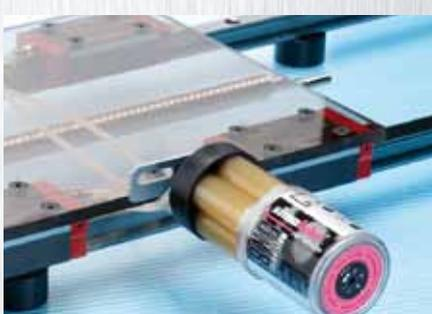
**Der simalube multipoint Schmierstoffspender mit der weltweit patentierten Gasentwicklungszelle als Antrieb versorgt 5 Schmierpunkte zuverlässig mit der benötigten Menge an Schmierstoff. Die Spendedauer ist stufenlos dosierbar zwischen 1 und 12 Monaten.**
