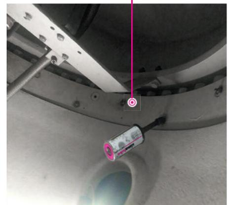
Automatische Schmierung mittels *simalube* 125 ml an einem Rotorblattlager.
