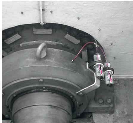
Zwei simalube 250ml schmieren das Hauptlager einer Windkraftanlage.
