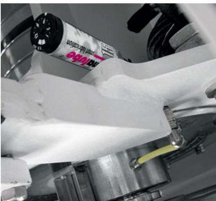
Selbst bei engen Platzverhältnissen schmiert der kleinste Schmierstoffspender zuverlässig und punktgenau.
