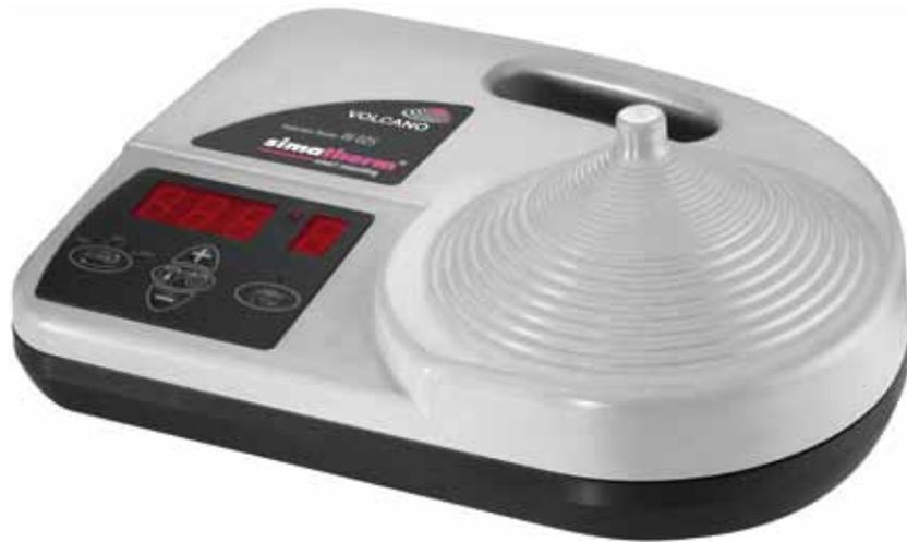
Das tragbare simatherm Induktions-Anwärmgerät für Wälzlager und andere ringförmige Eisenmetallteile ab 20 mm Innen- und bis 160 mm Aussendurchmesser. Mit der Zeit- und Temperaturautomatik lassen sich Wälzlager auf die von Herstellern vorgeschriebenen 110°C bzw. andere ringförmige Eisenmetallteile bis 180°C aufwärmen.
