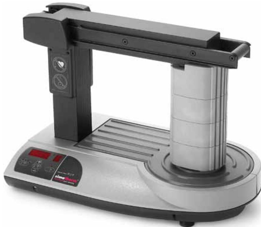
Das grosse simatherm Induktions-Anwärmgerät für Wälzlager und andere ringförmige Metallteile bis 600 mm Bohrung und 250 x 250 mm Querschnitt. Mit der Zeit- und Temperaturautomatik lassen sich Wälzlager auf die von Herstellern vorgeschriebenen 110°C bzw. andere ringförmige Metallteilen bis 400°C aufwärmen.
