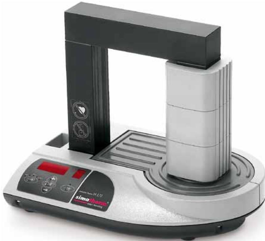
Das mittelgrosse simatherm Induktions-Anwärmgerät für Wälzlager und andere ringförmige Metallteile bis 400 mm Bohrung und 145 x 205 mm Querschnitt. Mit der Zeit- und Temperaturautomatik lassen sich Wälzlager auf die von Herstellern vorgeschriebenen 110°C bzw. andere ringförmige Metallteile bis 400°C aufwärmen.
