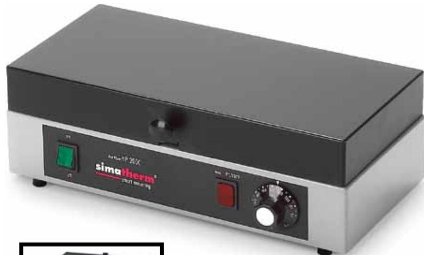
Die beiden elektrischen Anwärmplatten mit thermostatgesteuerter Erwärmung eignen sich speziell für kleine Lager und Maschinenteile. Die Temperatur lässt sich am Regler stufenlos zwischen 50°C und 200°C einstellen.
